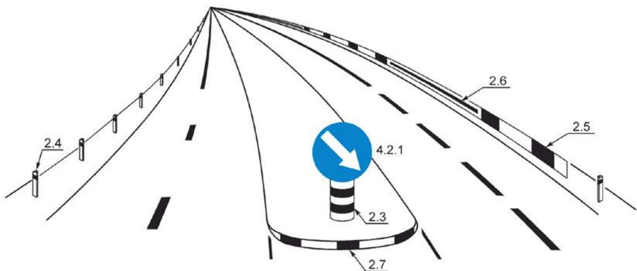
Рисунок В.24 - Пример нанесения разметки 2.3 - 2.7
