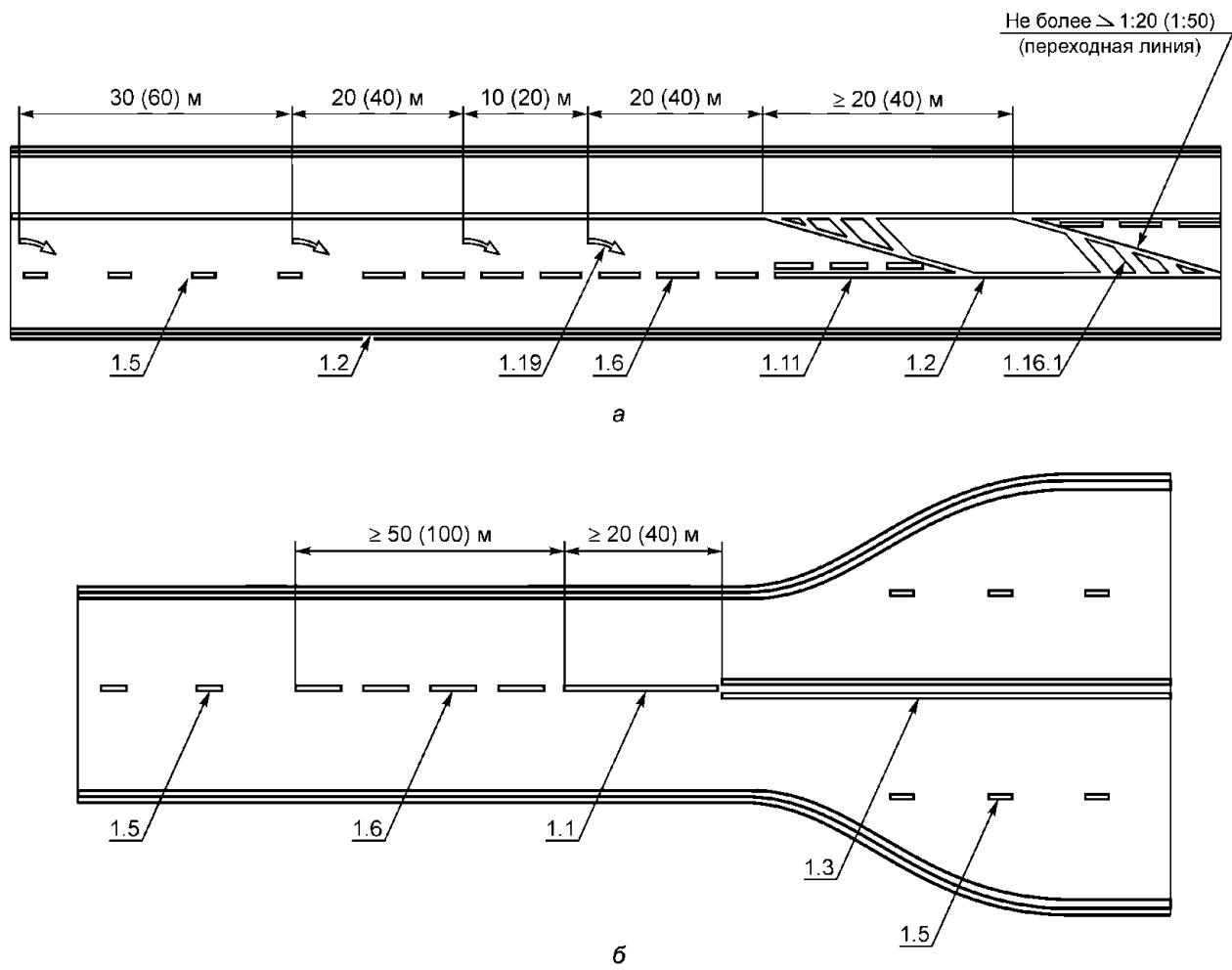
а - пример нанесения разметки при уменьшении количества полос;
