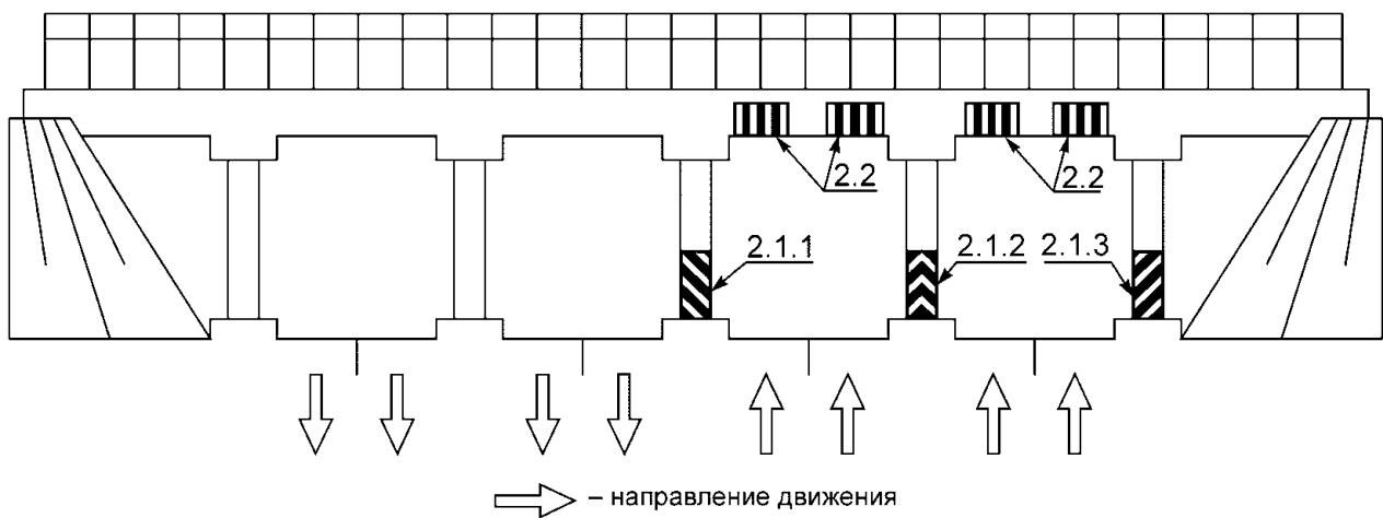
Рисунок В.22 - Пример нанесения разметки 2.1 и 2.2
