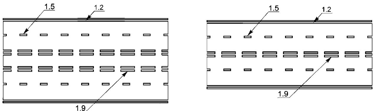
Рисунок В.17 - Примеры нанесения разметки 1.9
