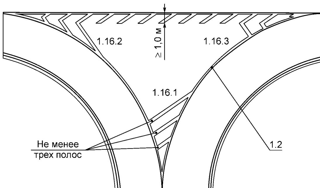
Рисунок В.12 - Пример нанесения разметки 1.16.1 - 1.16.3
