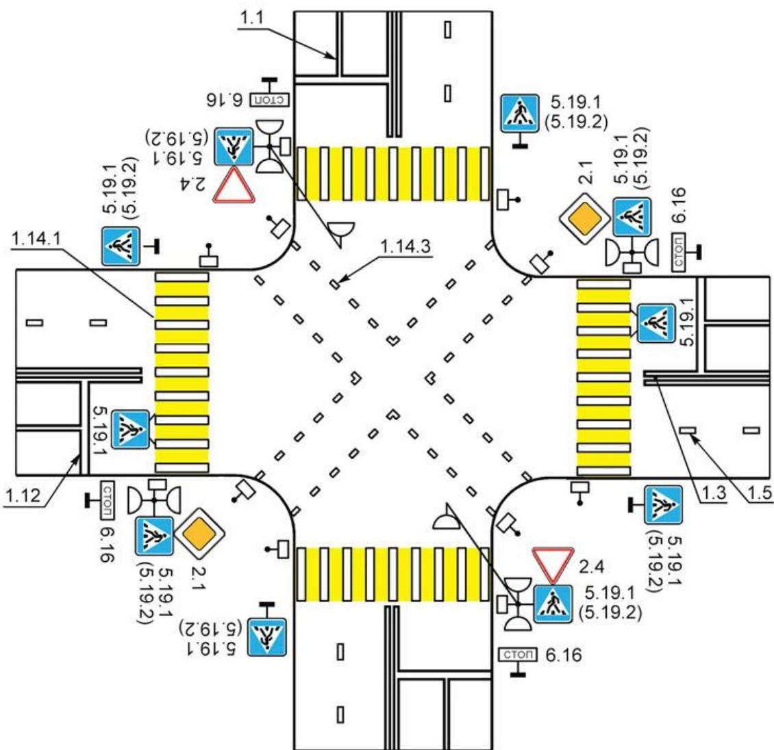
Рисунок В.19 - Пример нанесения диагонального пешеходного перехода
