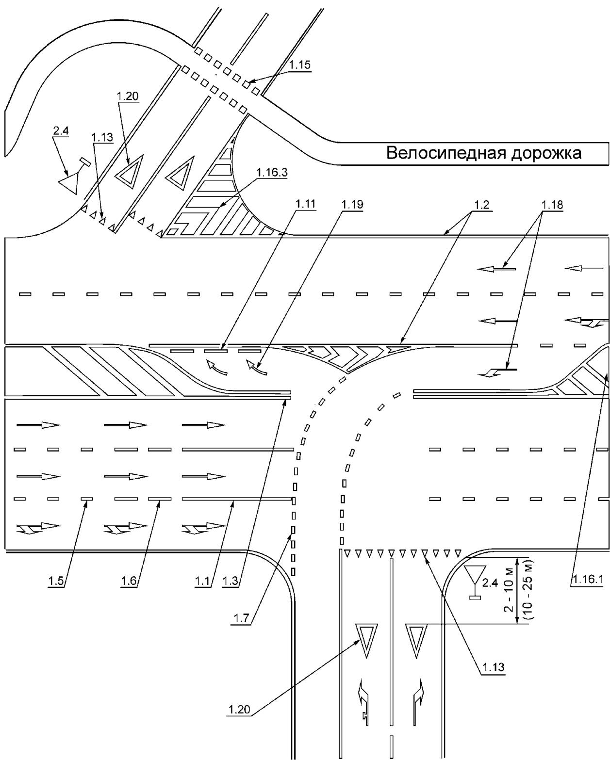
Рисунок В.10 - Пример нанесения разметки канализированного пересечения
