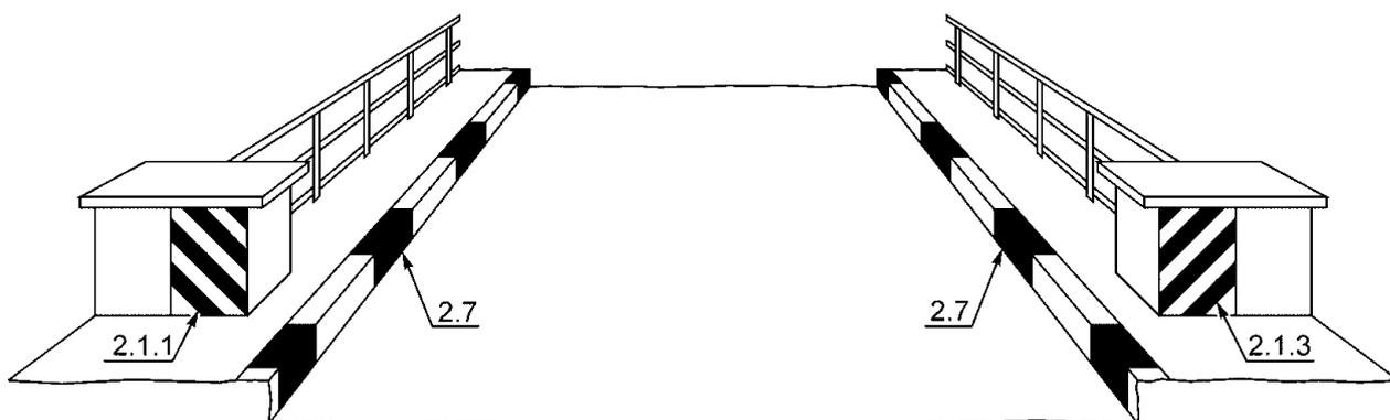
Рисунок В.23 - Пример нанесения разметки 2.1.1, 2.1.3 и 2.7
