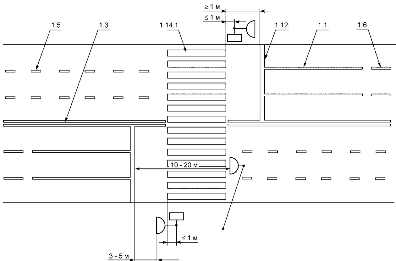
Рисунок В.20 - Пример размещения светофоров и нанесение
