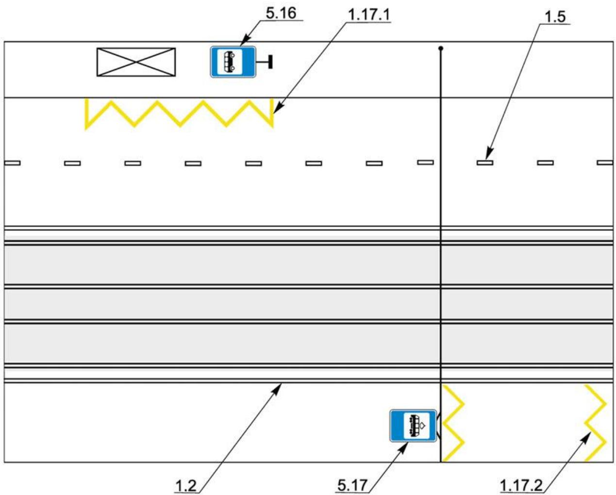
Рисунок В.15 - Пример нанесения разметки 1.17.1 и 1.17.2
