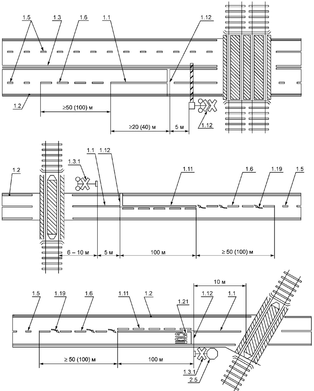
Рисунок В.18 - Примеры разметки участка дороги на подъезде к железнодорожному переезду
